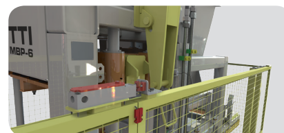
Cercas de proteção. Protection cage. Cercas de protección.
