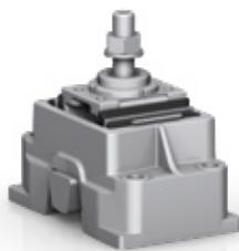
Die Schichtlager der V Serie, entwickelt für die Lagerung zusammengebauter Motor-Getriebe-Antriebsanlagen, kombinieren hervorragende Schwingungsisolierung mit Propellerschubübertragung. Das bereitgestellte Steifigkeitsverhältnis ermöglicht eine hohe Schubübertragung mit geringen Verlagerungen. Die V Serie ist in zwei Größen mit integriertem Begrenzer und Höhenverstellung erhältlich.
