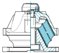
Die konischen Lager der T Serie, entwickelt für die Lagerung von Antriebsanlagen und Stromaggregaten, vereinen hervorragende Schwingungsisolierung mit Stabilität unter Seegangbedingungen und einem integrierten Verlagerungsbegrenzer. Vorgespannt erhältlich in 13 verschiedenen Größen und drei Ausführungen passend zur jeweiligen Anwendung.
