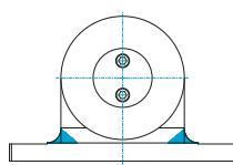
Die AVR Serie ist für die stabile Lagerung von Getrieben konzipiert. Sie ermöglicht über die Lagerung sowohl hohen Propellerschub als auch hohe Drehmomentübertragung mit geringen Verlagerungen. Die Schwingungsisolierung ist optimal auf die Zahneingriffs frequenzen ausgelegt. Erhältlich in drei Größen und Standardgehäuse für viele verschiedene Einsatzbereiche.
