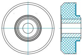
Die CV 2000 Serie wurde für die stabile Getriebe- und Motorlagerung als vorgespannte Sandwich-Scheiben entwickelt. Die Schwingungsisolierung ist ebenfalls optimal für die dominante Anregung der Zündfrequenz der Motor- und Getriebelagerung. Erhältlich in verschiedenen Steifigkeiten mit Sonderhalterungen für die jeweilige Anwendung.
